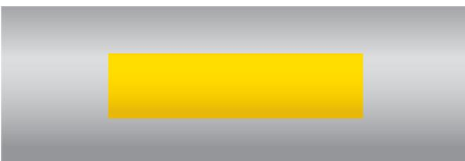
Окраску трубопроводов следует выполнять сплошной по всей поверхности коммуникаций. Однако поверхности трубопроводов, на которых сплошная окраска нецелесообразна по технологическим или конструктивным причинам (например: поверхности из нержавеющей стали, оцинкованные поверхности и др. поверхности со специальными видами покрытий) допускается окрашивать отдельными участками. Ширина и вид участков опознавательной окраски по **ГОСТ 14202-69**.
